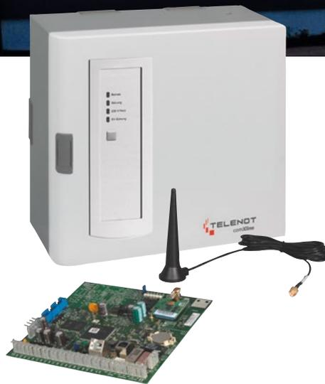
Die Übertragung von Alarmmeldungen erfolgt auf mehreren voneinander unabhängigen Wegen. So ist sichergestellt, dass eine Alarmierung auch dann erfolgt, wenn ein Übertragungsweg ausfällt.
